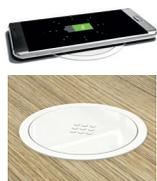
**Chargeur Qi sans fil** : témoin lumineux LED lors du chargement, puissance : entrée DC 5V 2A, sortie 5W max 1A, diamètre de l'obturateur (perçage) : 80 mm, livré avec 1 cordon d'alimentation (2m), coloris blanc.
